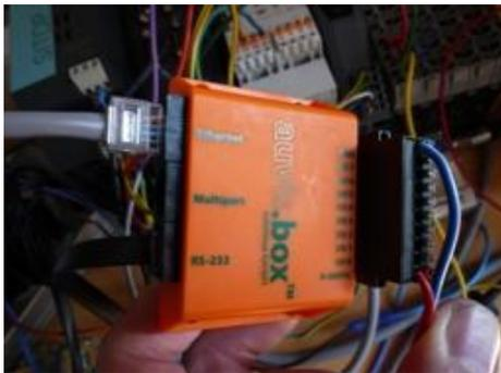
Bild: ATV\_Web\_IO Modul (Fertigerät)
