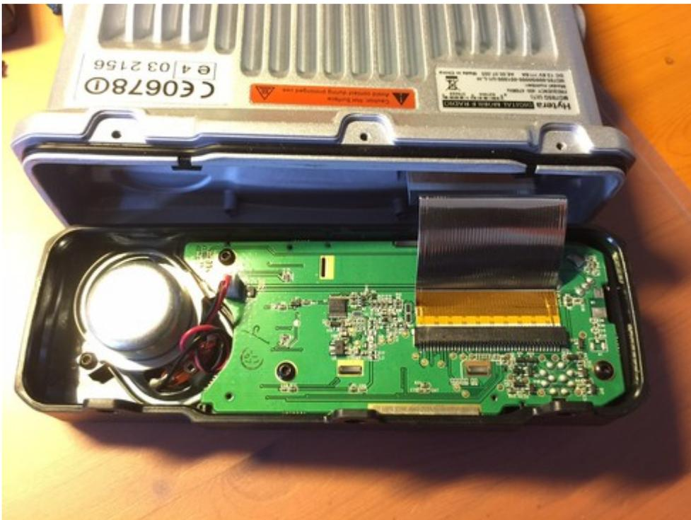
Im Gegensatz zu Volker bevorzugte ich den Einbau eines Trimpotentiometers, um bei der Einstellung variabel zu sein. Mit Hilfe des Trimm-Potis lässt sich nun, ganz nach Geschmack, das Verhältnis Komfortauschen zu NF-Signal leicht einstellen:
