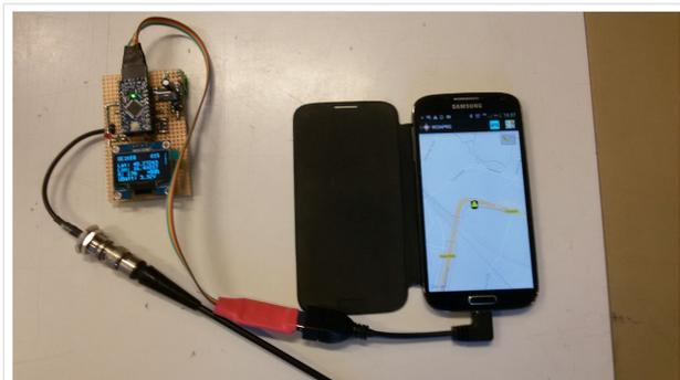
LoRa Empfänger mit angeschlossenen Handy mit Positionsanzeige via W2APRS
