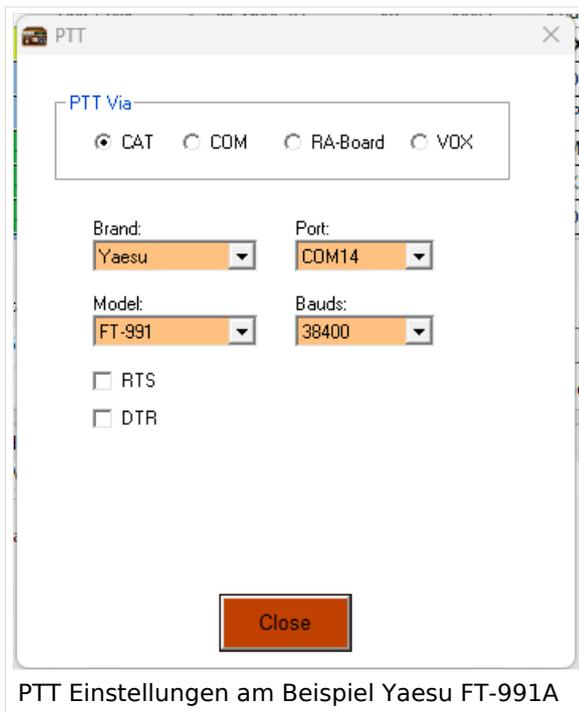
Bei Verwendung eines modernen Transceivers mit USB-Schnittstelle, wie z.B. dem FT-991A kann man die CAT-Steuerung auswählen - dabei das richtige Modell, Com-Port und Baudrate einstellen!
