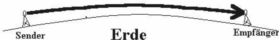
Diesen Ausbreitungsweg, bei dem die Wellen quasi parallel zum Erdboden laufen, nennt man Bodenwellenausbreitung, oder kurz 'Bodenwelle'.
