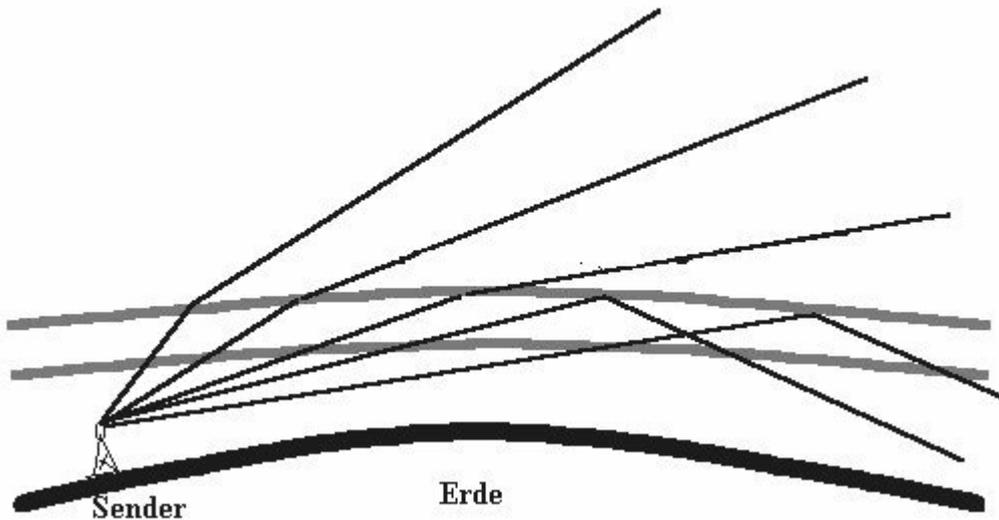
Bei extrem günstigen Bedingungen (maximale Ionisation, flachster möglicher Winkel) ist die Grenzfrequenz der Ionosphäre 30 MHz. Alle höherfrequenten Wellen werden ohne Ausnahme in den Weltraum durchgelassen.
