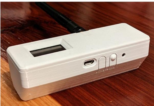
TBEAM Gehäuse mit Tasten und OLED
