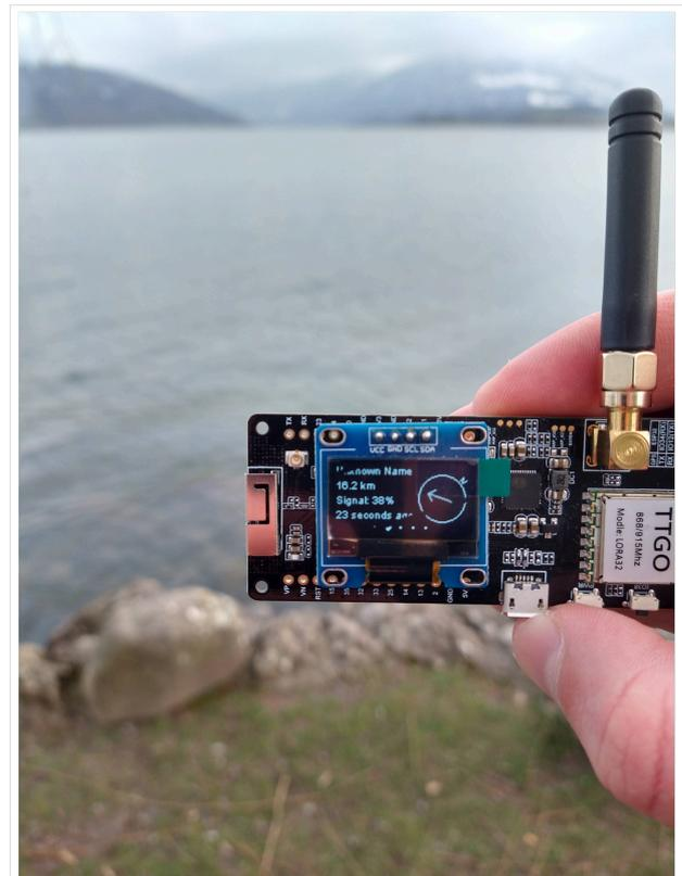
TBEAM Lora mit OLED-Display
