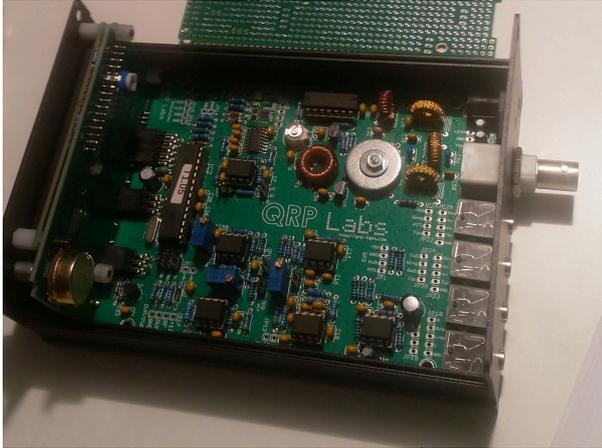
Der [QCX+](#) (**QRP CW Xcvr +**) ist ein monobandiger 5W, Morse-Transceiver als Bausatz mit eingebauter [WSPR](#) Bake, sowie Abgleichhilfe und Systemtest. Der Bausatz ist erhältlich für 80, 60, 40, 30, 20 oder 17m Band. Neben dem ursprünglichen [QCX](#) Bausatz (2017) gibt es zwei weitere Varianten: [QCX+](#) (seit Juni 2020) und [QCX-mini](#) (seit Dezember 2020). Siehe [QRP-Labs Webseite](#).
