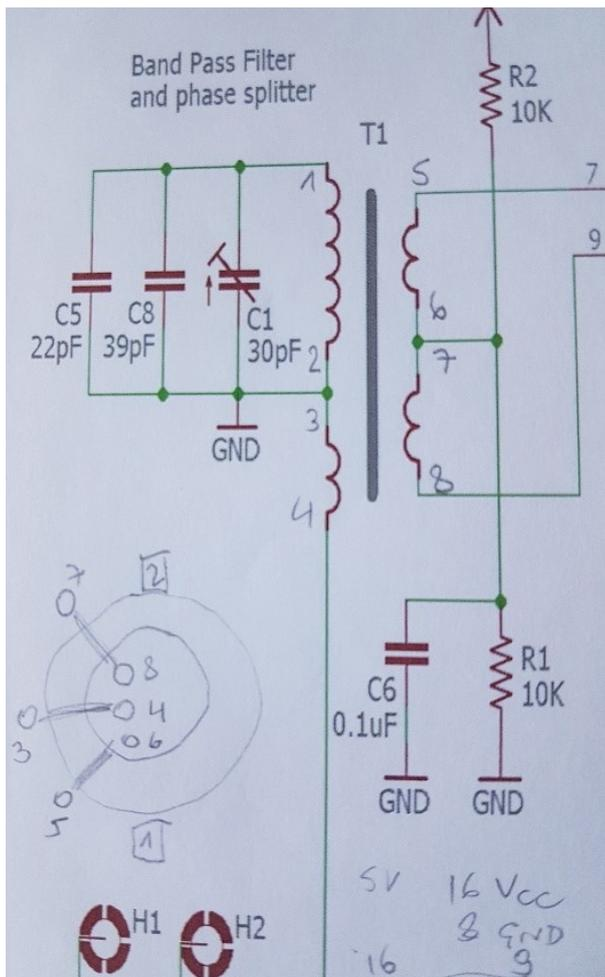
Nun mit einem Messgerät (Vielfachmessgerät – auf akustischen Ton bei Kurzschluss gestellt) überprüfen, ob alle Verbindungen stimmen und keine Kurzschlüsse oder schlechte Lötverbindungen vorhanden sind. Wie man aus dem Ausschnitt des Schaltbildes sehen kann, sollten bei den Punkte 1-2-3-4 eine Verbindung vorhanden sein. Ebenso zwischen 5-6-7-8.
