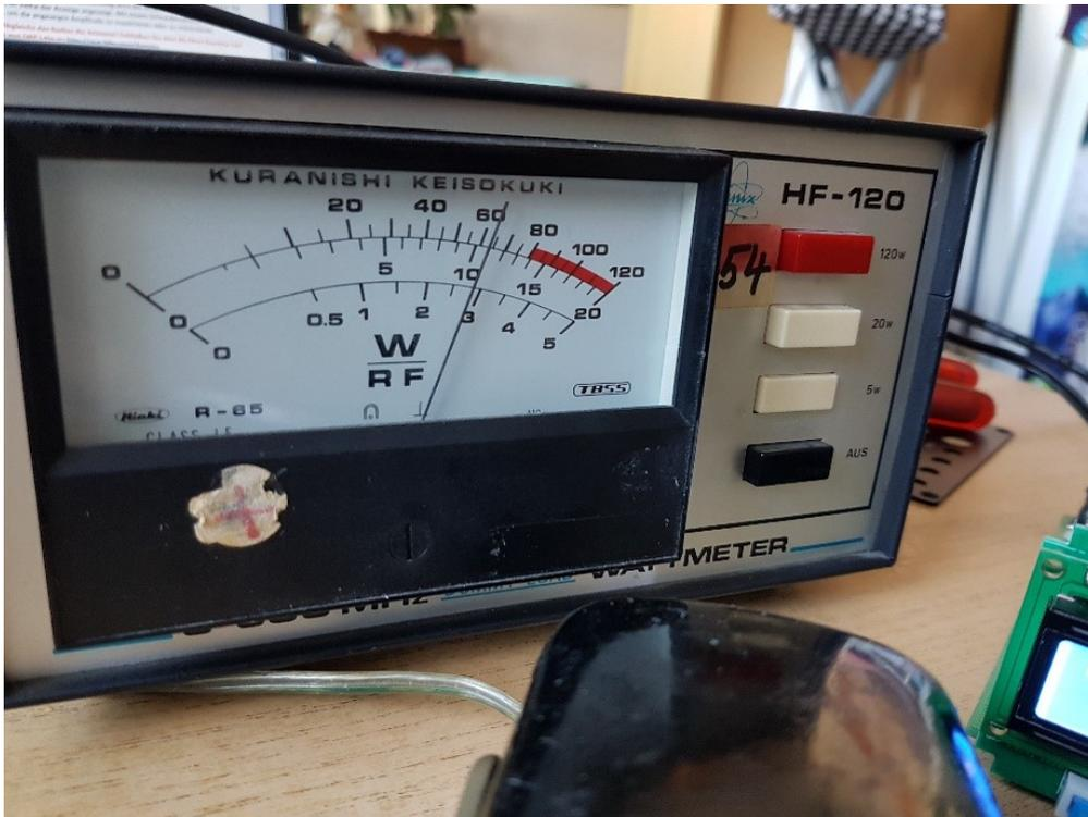
Nun wurden beim Ringkern L3 zwei Windungen entfernt, um mehr Leistung zu erreichen. Bei 12V erreiche ich nun 4 Watt. Bei 13.8V sind es 5.5W.
