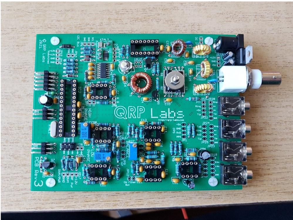
Nun wurden alle IC's auf die Sockel montiert. Dazu ist es bei den IC's immer notwendig, dass die Kontakte ein wenig nach innen gebogen werden müssen. Am besten immer auf der Seite an einer geraden Fläche schräg auflegen und alle Kontakte einer Seite leicht nach innen drücken (aber nur so lange bis beiden Seiten leicht auf den Sockel passen).
