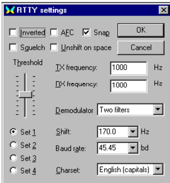
Wählen Sie Mode > RTTY im Menü oder durch Klicken auf die Sendart im Statusbalken. Gehen Sie innerhalb von RTTY zu Mode > Mode Settings : Inverted anklicken, werden Mark und Space vertauscht. Zweckmäßig ist auch Unshift on Space außerhalb von Contesten zu setzen, um automatisch ins Buchstabenregister zurückzuschalten. Sie können 4 Sätze mit Kombinationen von Baudraten, Shift, Zeichensätzen usw. anlegen und anwählen. Schalten Sie durch Anklicken der Set-Nummer von einem Satz zum anderen.
