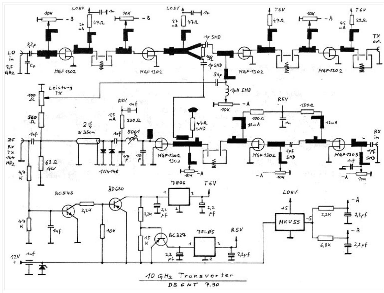
1992 beschrieb Peter Vogl, DL1RQ anlässlich der VHF-UHF-Tagung in München einen dritten Transverter, der mit einer Zwischenfrequenz im 70 cm-Band arbeitete und mit Microstripline-Filter ausgeführt war.
