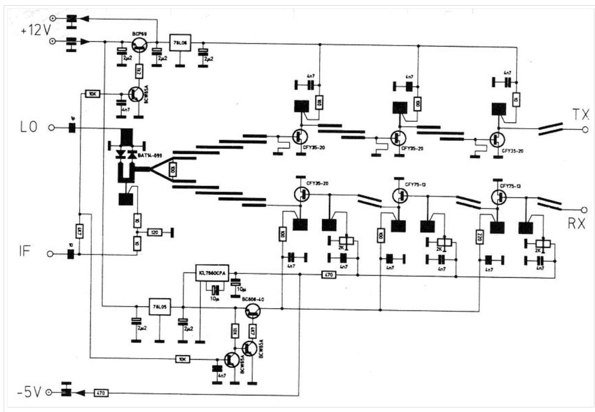
1993 beschrieb Sam Jewell, G4DDK, im DUBUS Magazin 3/93 sowie im DUBUS Technik BUCH IV seinen Transverter. Das System bestand aus mehreren Einzelbaugruppen und Leiterplatten. Die Baugruppen waren auch als Bausatz (von G3WDG) erhältlich.
