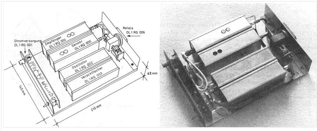
1987 veröffentlichte Heino Schübbe, DJ6JJ, im DUBUS Magazin 2/87 einen Transverter, der alle Stufen auf einer Teflonleiterplatte vereinigte. Damit war der "Einplatinen-Transverter" geboren. .
