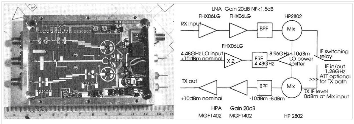
1997 beschrieb Matjaz Vidmar, S53MV, im DUBUS Magazin 3/97 sowie im Technik Buch IV einen SSB Transceiver mit Direktmischung nach der Phasenmethode.
