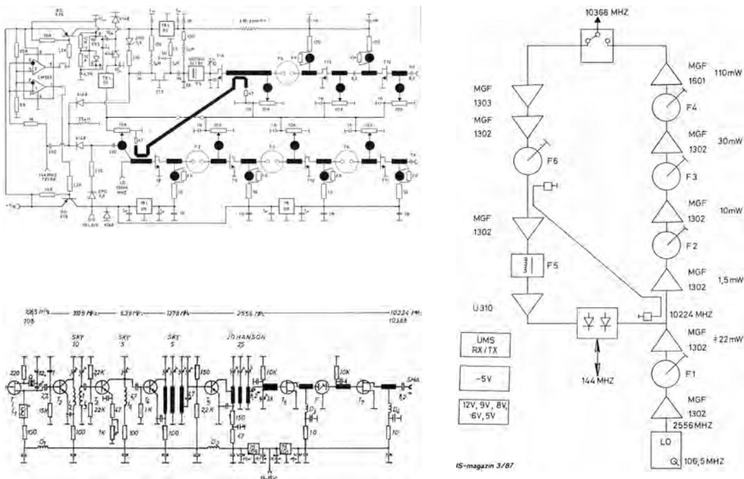
1988 beschrieb **Jürgen Dahms, DC0DA**, anlässlich der VHF-UHF-Tagung in München einen ersten 10 GHz-Transverter, der auch als "Portable-Simple" bezeichnet wurde. Wie der Name schon verrät, ist die Schaltung sehr einfach gehalten und als Einstiegsprojekt für 10 GHz geeignet.
