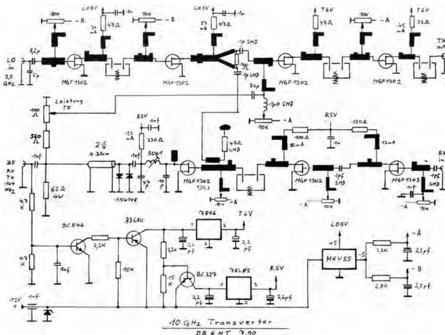
**1992** beschrieb **Peter Vogl, DL1RQ** anlässlich der VHF-UHF-Tagung in München einen dritten Transverter, der mit einer Zwischenfrequenz im 70 cm-Band arbeitete und mit Microstripline-Filter ausgeführt war.
