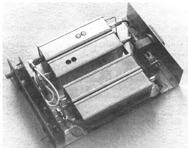
1987 veröffentlichte **Heino Schübbe, DJ6JJ**, im DUBUS Magazin 2/87 einen Transverter, der alle Stufen auf einer Teflonleiterplatte vereinigt. Damit war der "Einplatinen-Transverter" geboren.
