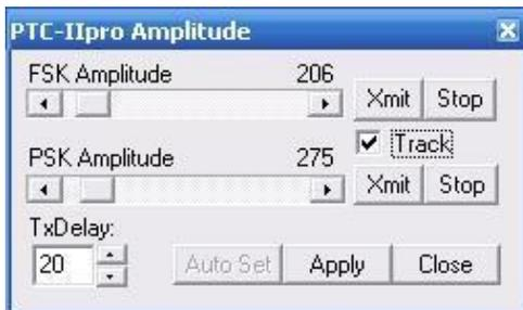
Nun stellt man sicher, dass der Audio-Kompressor am Transceiver ausgeschaltet ist, schaltet das Transceiver Messinstrument auf ALC, klickt auf 'Xmit' im Tool und stellt die Amplitude mit dem Schieber so ein, dass die ALC **minimal** (höchstens ein Teilstrich) wirksam wird. Mit „Apply“ wird diese Einstellung abgespeichert.
