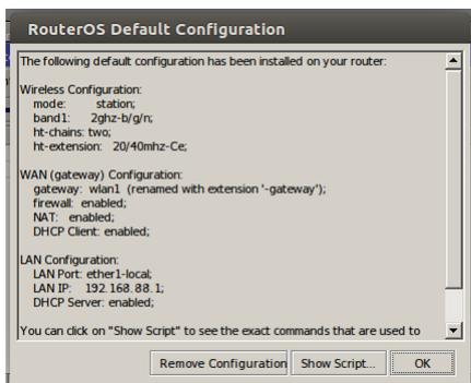
Mit „Remove Configuration“ wird die Standardkonfiguration entfernt und wir können uns den Router für das HAMNET vorbereiten. Sicherheitshalber empfiehlt sich noch ein Reboot in System/Reboot.
