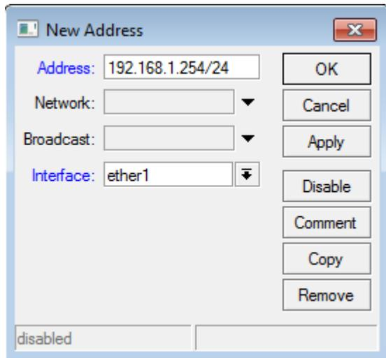
Nach dem Betätigen des Button „Apply“ sollte die Maske sinngemäß wie folgt aussehen.
