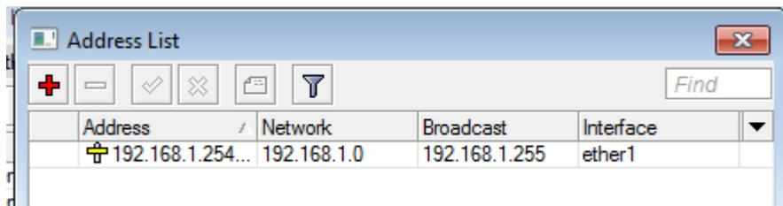
**ACHTUNG:** Wenn man die Adresse später ändert muss man auch die Felder Network und Broadcast ändern. Die werden NICHT automatisch angepasst. Am einfachsten die Felder leeren, IP-Adresse mit Netmask in der Form 192.168.1.123/24 eingeben, dann Apply drücken. Die richtigen Werte werden dann automatisch eingetragen.
