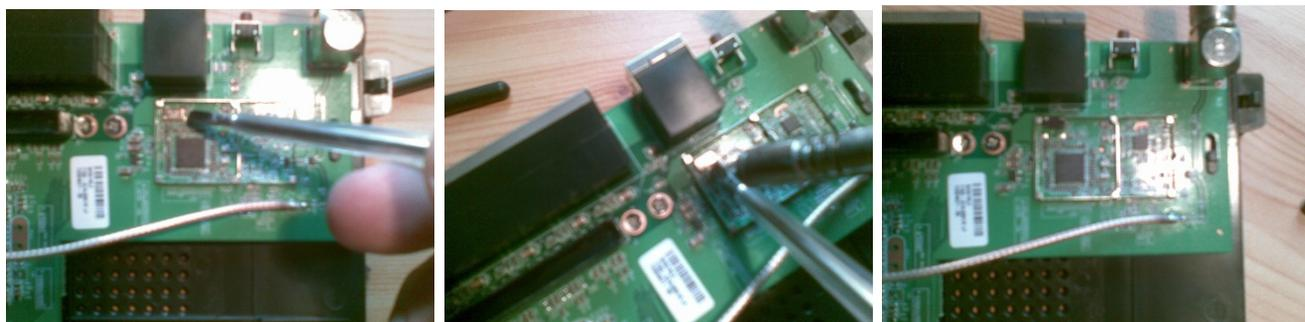
Wenn Oszillator draussen ist, dann die Pins Nord/Ost und Süd/West bzw 2 & 4 Verzinnen und Quarz darauf verlöten (1 ist der frei Pin links oben). Quarz entsprechend verlöten und Abschirmung entsprechend verkürzt
