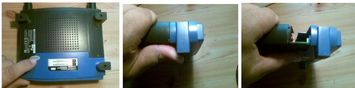
Entfernen des Klebers rückseitig, Abschrauben der Antennen und Abheben des Hauptgehäuses,
