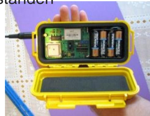
Bild: Byonics Micro-Trak AIO
